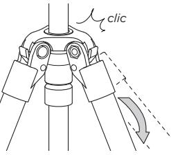
Fermer la section jusqu'au «clic» suivant. C'est la position normale.
