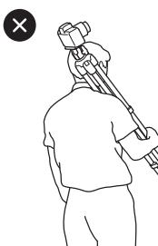
Ne pas transporter le trépied lorsque l'appareil est toujours attaché à la tête.
