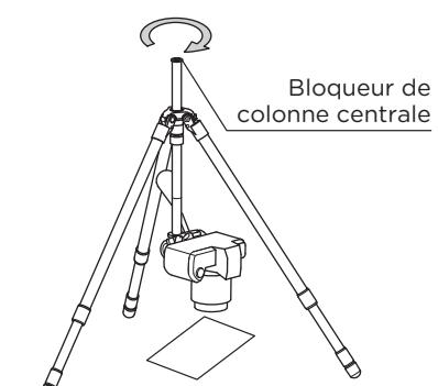
Insérer la colonne centrale de bas en haut et serrer le verrouillage. Penser à remettre le bloqueur en place pour éviter que l'ensemble ne tombe accidentellement.
