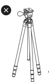
Vérifier que les leviers, verrous et poignée sont bien serrés avant d'attacher l'appareil. Vérifier que les trois sections sont ouvertes au maximum.
