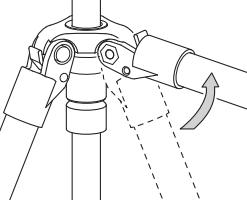
Relever la section jusqu'à la butée. C'est la position basse.
