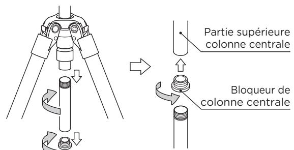
tourner la partie inférieure de la colonne centrale et le bloqueur dans le sens inverse des aiguilles d'une montre. Attacher le bloqueur à la partie supérieure de la colonne centrale pour éviter qu'elle ne glisse.
