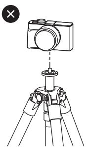
Ne pas attacher un appareil directement sur la vis dédiée à la tête panoramique au risque d'endommager l'appareil et le trépied.
